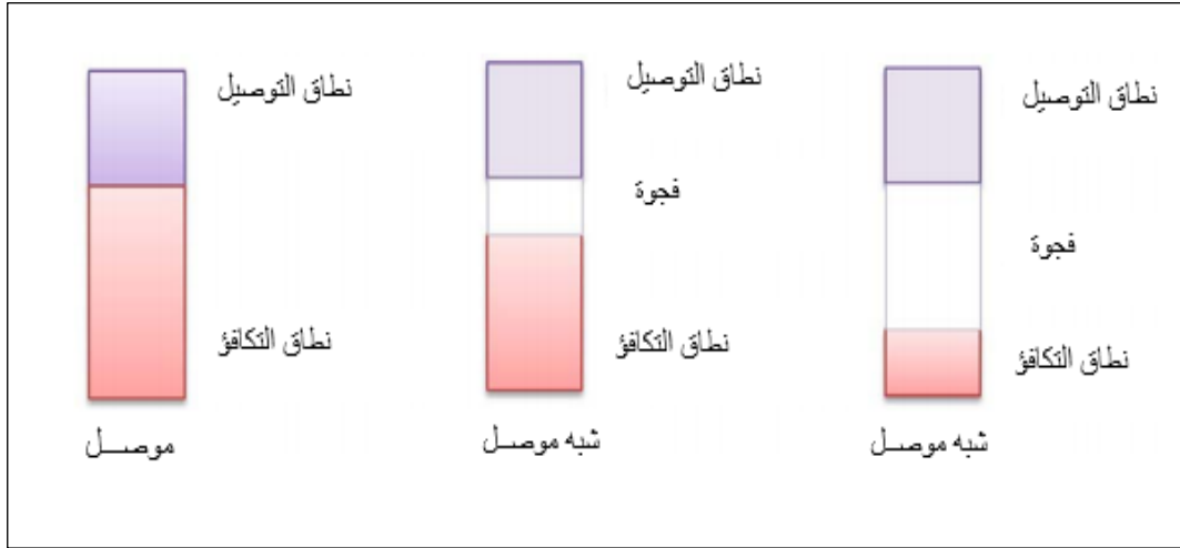
الشكل 3.I: مبدء عمل نطاق التكافؤ وفجوة النطاق (GAP) ونطاق التوصيل عازل وموصل وأشباه موصلات [62].
