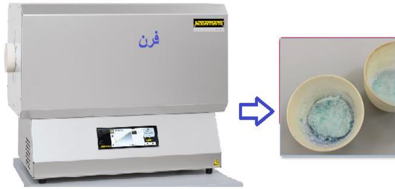
الشكل (2-2): تشكل سيليكات الصوديوم بعد عملية الحرق.
