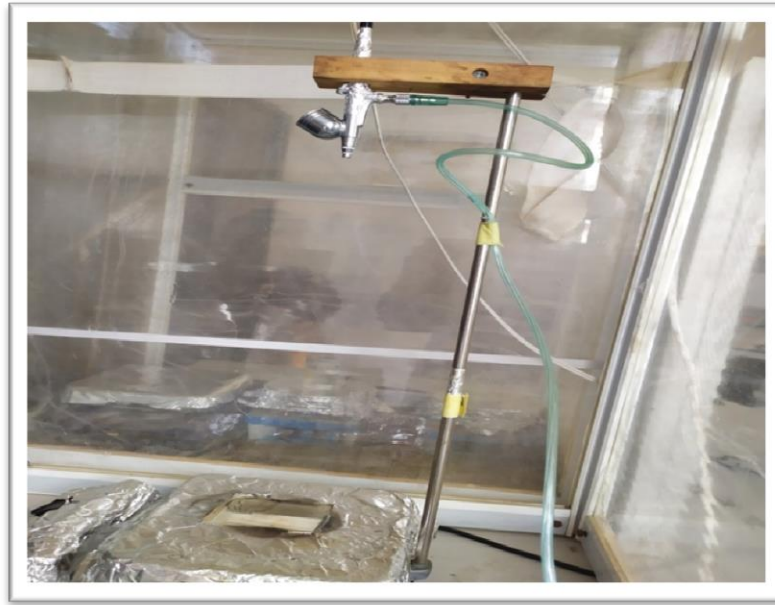
الشكل (III – 1) : التركيب التجريبي لترسيب الاغشية الرقيقة بتقنية الرش الكيميائي الحراري .
