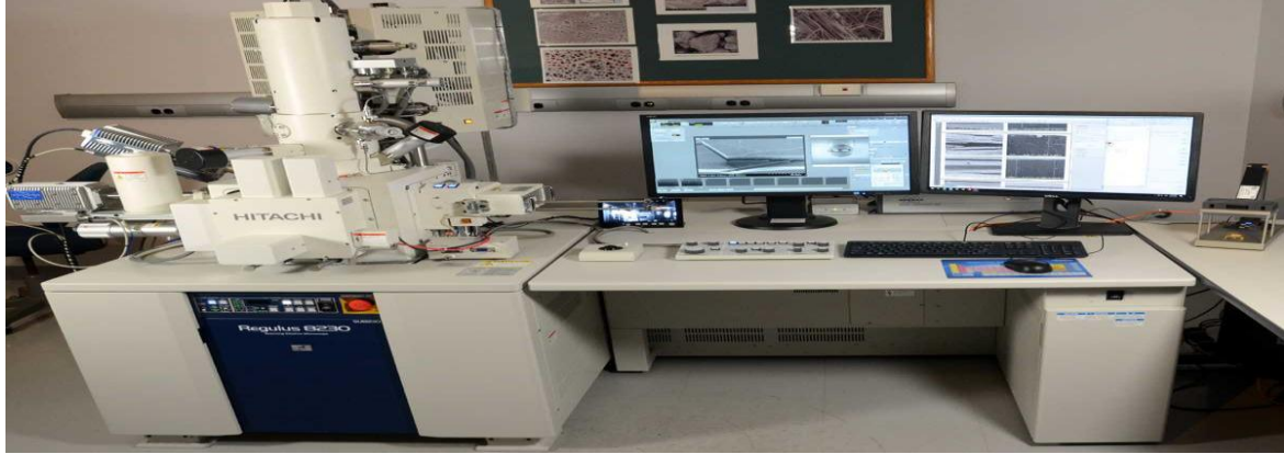
الشكل 8 : يوضح صورة فوتوغرافية للمجهر الإلكتروني الماسح وملحقته [40] .
