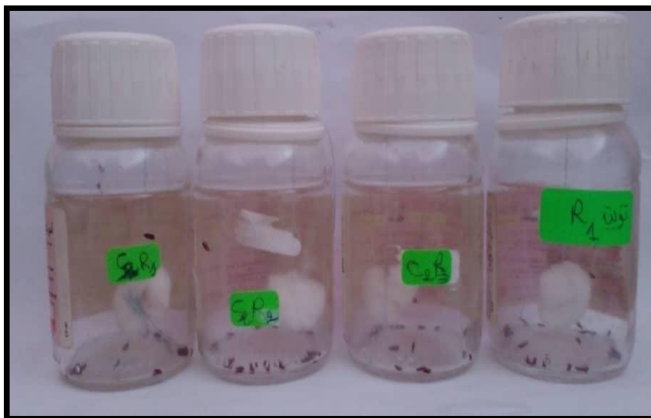
Figure 14: Tests de fumigation d'huile et d'extrait de graines de Cucurbita maxima sur les adultes de T. castaneum (Originale, 2026)
