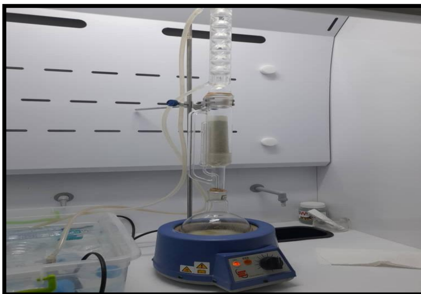
Annexe 6: Extraction d'huile de graines de Cucurbita maxima à l'aide d'un Soxhlet
