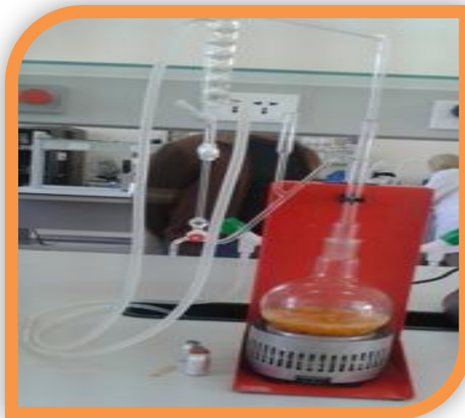
Figure 14 : Appareil Clevenger modifié
