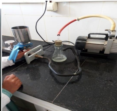
Figure.23. Filtration sous vide.
