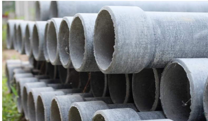
Figure II-11: Conduites en amiante – ciment.
