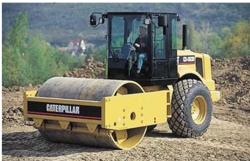
Figure VI-3: L'engin Pour le compactage.
