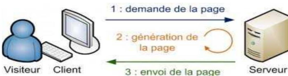
Figure I.4 : Fonctionnement d'un site web entièrement dynamique
