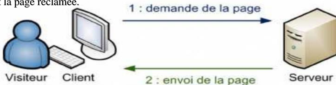
Figure I.3 : Fonctionnement d'un site web entièrement statique
