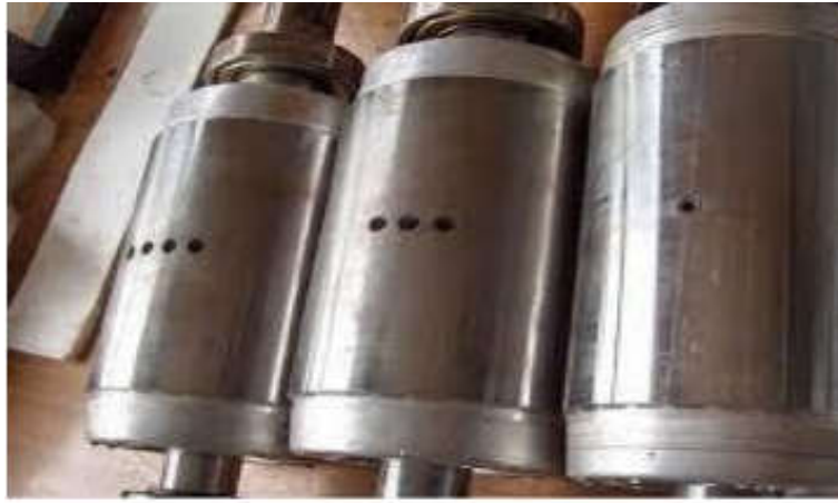
Fig. I.11 : Défaut d'un rotor à cage d'écureuil
