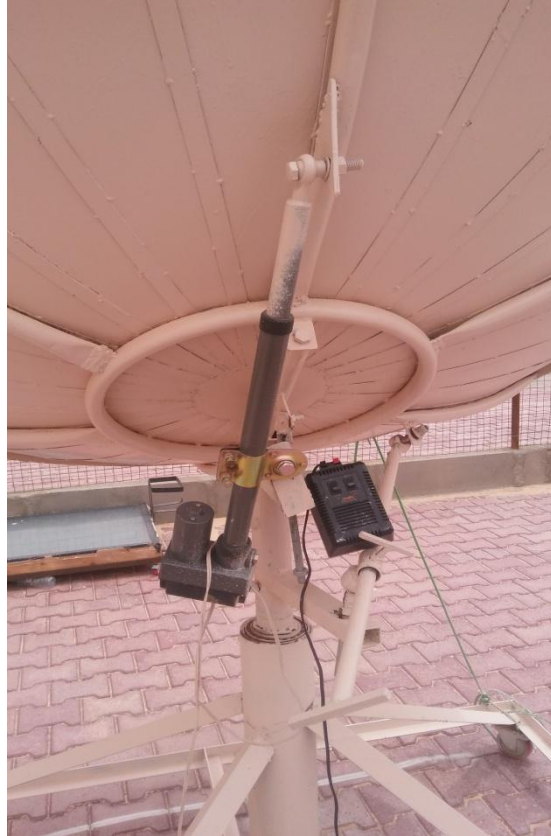
Figure. II.8: Photo du système de poursuite contenant un vérin et un axe rotatif.
