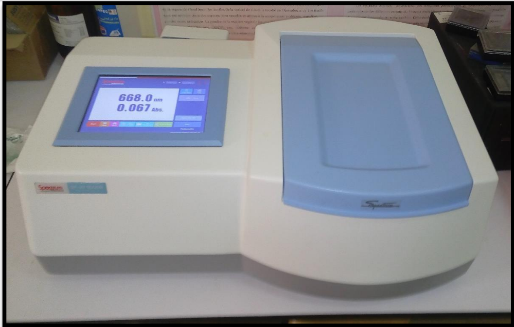
Figure II.5: Image d'un spectrophotomètre ultraviolet (SP-UV 500DB)
