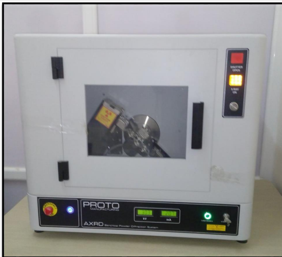
Figure II.3 : Image d'un diffractomètre de type (PROTO)
