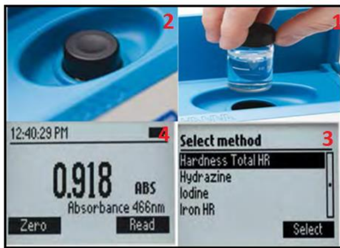
Figure 13. Etapes d'analyse spectrophotométrie de l'appareil HI38200
