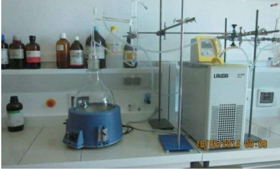
الصورة رقم 21: مرحلة استخلاص الزيوت بواسطة جهاز كليفنجر (Clevenger)
