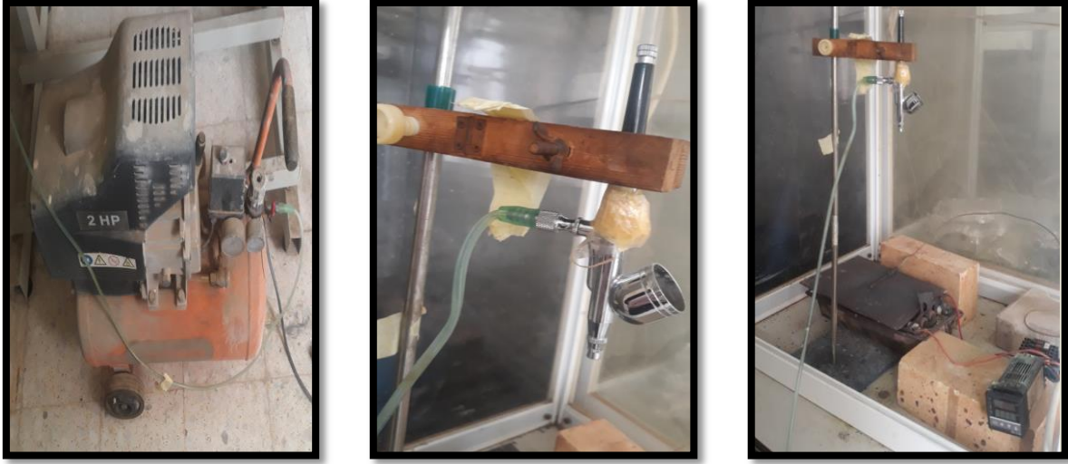
الشكل (III-2): يوضح منظومة الرش المستعملة في عملية تحضير الأغشية الرقيقة.
