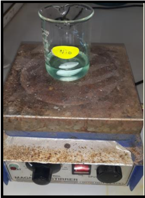
الشكل (4-III): خطوات تحضير محلول نترات النيكل.
