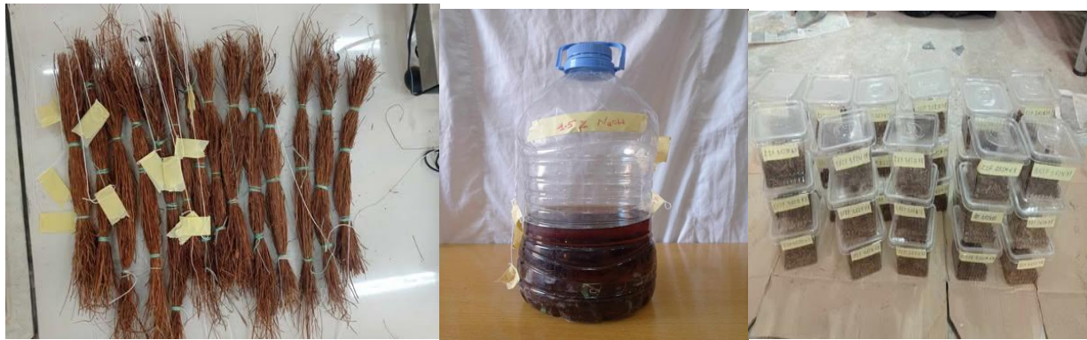
Figure II.4. (a) Faisceau de fibres, (b) Fibres traitées au NaOH. (c) Morceaux de fibres lavées à l'eau distillée
