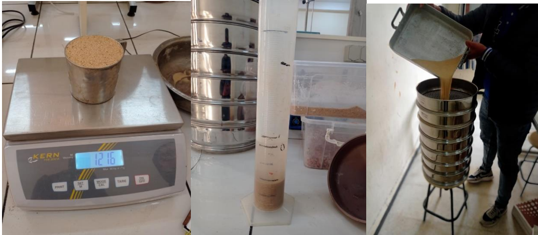
Figure II-6 : Mesure de la masse volumique des granulats, l'équivalent de sable et tamisage des granulats.
