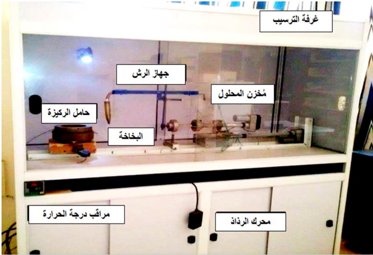
الشكل (1.III): التركيب التجريبي لترسيب الأغشية الرقيقة بتقنية الرش بالإنحلال الكيميائي الحراري.
