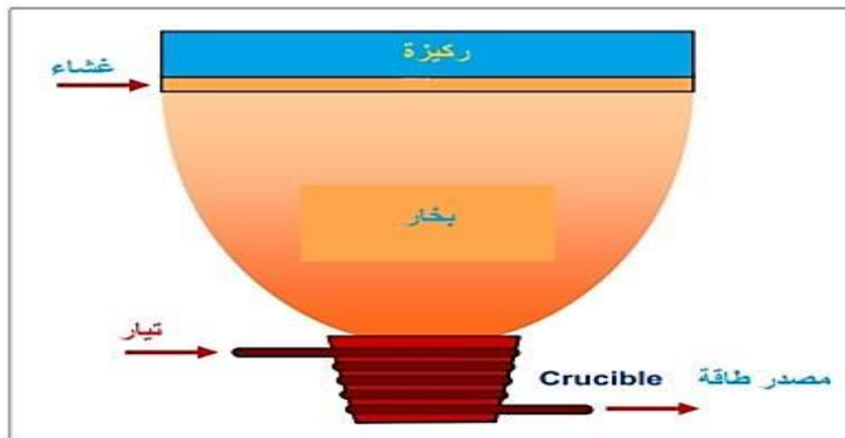
الشكل (3.II): رسم يوضح ترسيب الأغشية الرقيقة بطريقة التبخير (Evaporation). [12]
