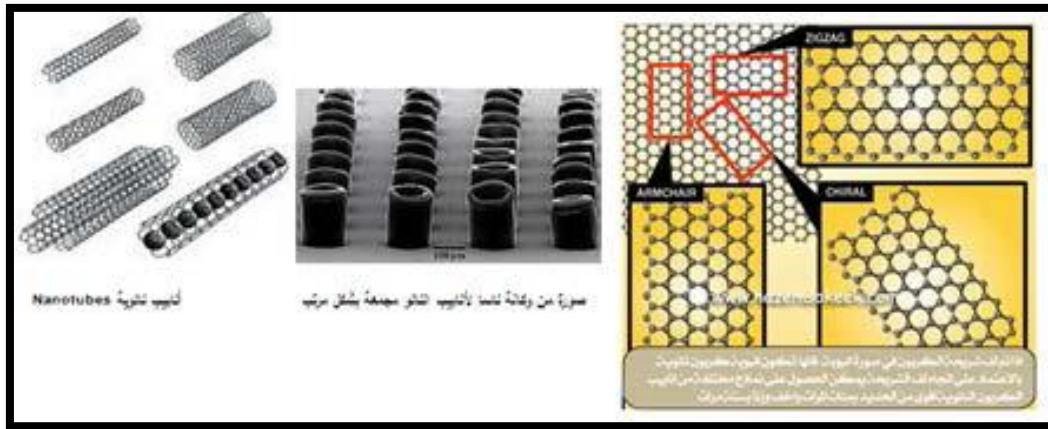
الشكل (1.I): يمثل الأشكال المختلفة للأنابيب النانوية و طرق الحصول عليها.
