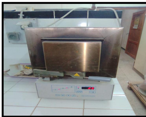
الشكل (6.II): الفرن الكهربائي المستعمل لتلدين..
