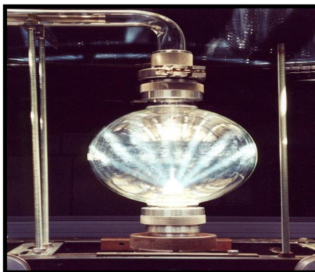
الشكل (8.I): الصورة الطبيعية للمفاعل المستعمل لتحضير المساحيق النانوية.
