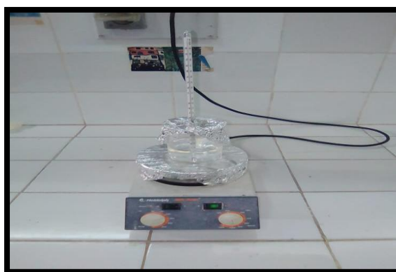
الشكل (4.II): عملية رج المزيج فوق المخلاط المغناطيسي.
