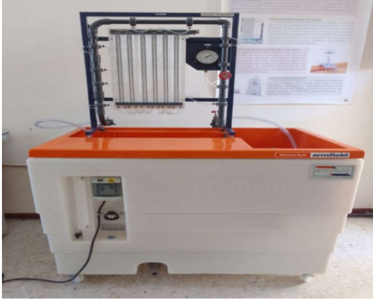
الشكل (3-1): جهاز دراسة فقدان الشحنة في وصلات الأنابيب [17]
