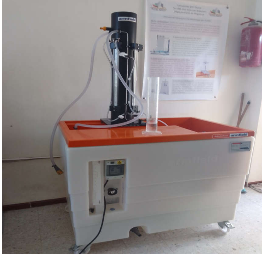
الشكل (5-3):جهاز دراسة فقدان الشحنة الناتج عن الاحتكاك داخل الأنابيب
