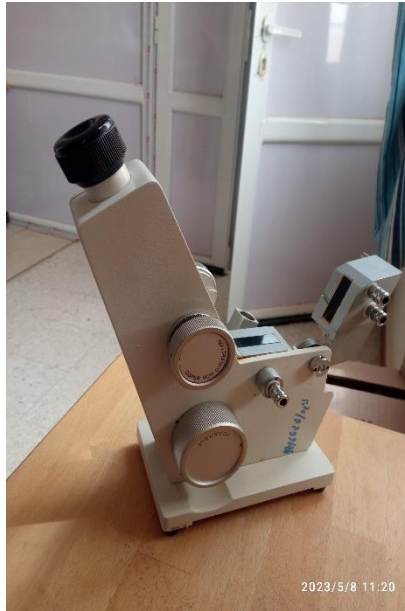
صورة (06) : جهاز ريفاركتومتر
