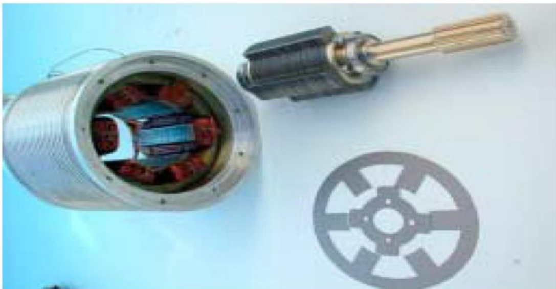
Figure (II.1) machine à réluctance variable Pures 6/4. [35]
