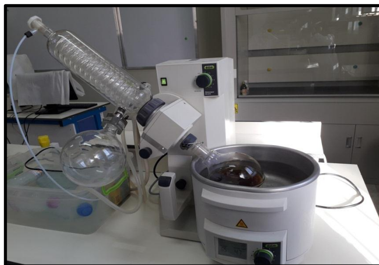
Figure: Évaporateur rotatif de type Büchi Rotavapor R-200 (photo originale).
