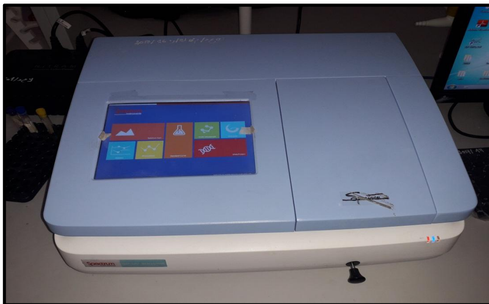
Figure: Spectrophotométrie à transmission moléculaire de type UV- VIS -1240 (photo originale).
