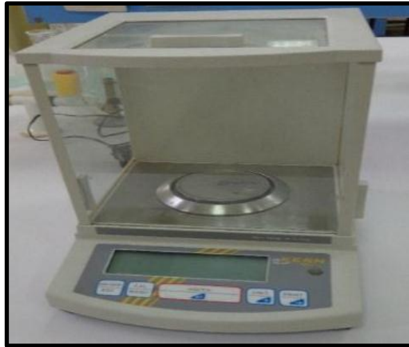
Figure: Balance électrique de type KERN EMB 2200-O (photo originale).
