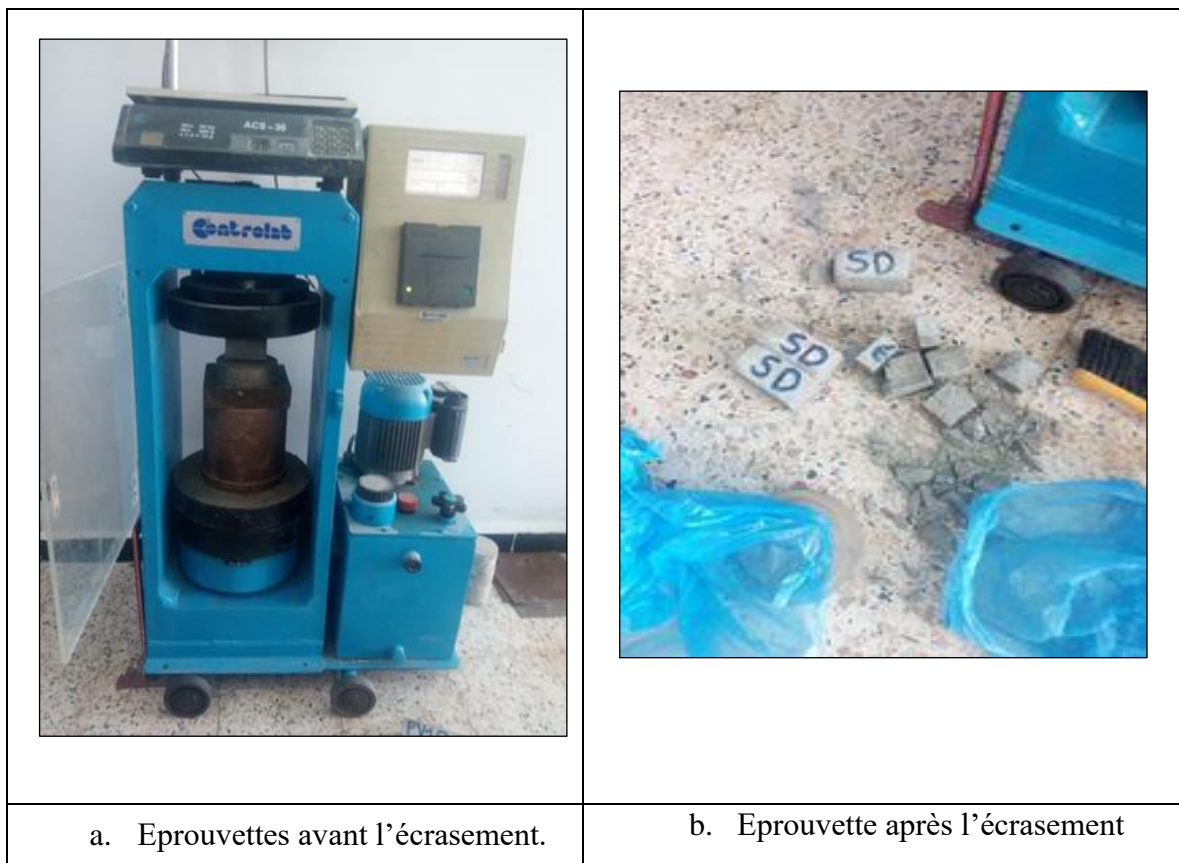
Figure II.13. Procédé de l'essai de rupture par compression.
