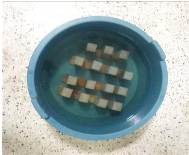
Figure II.14. Procédure de l'essai d'absorption d'eau par immersion totale.
