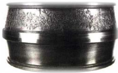
Figure (II.12) : Défaut de roulement – écaillage [6]
