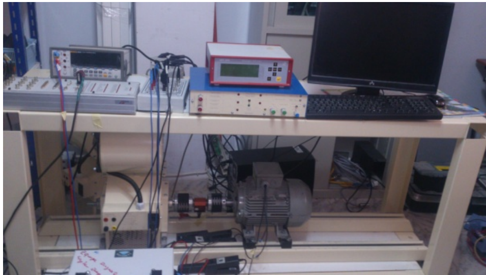
Figure (III.1) : Photo du banc d'essai dédié au diagnostic
