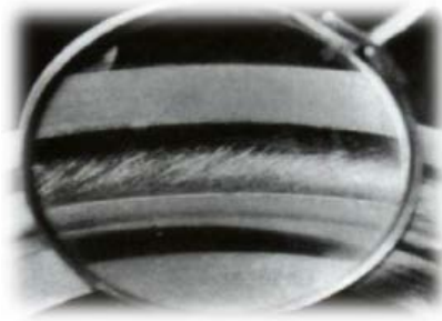
Figure (II.11): Défaut de roulement – bavure [6]
