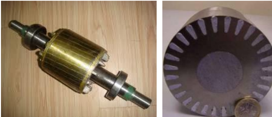
Fig I.3. Construction du rotor
