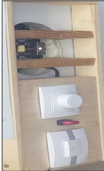
Figure III.7 : respirateur de séchoir avec variateur de vitesse d'air
