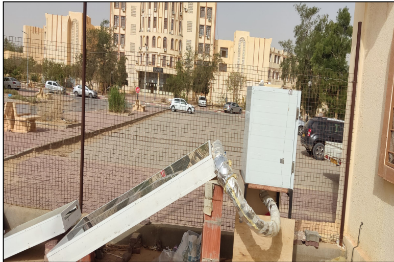
Figure III.10: capteur solaire et chambre de séchage
