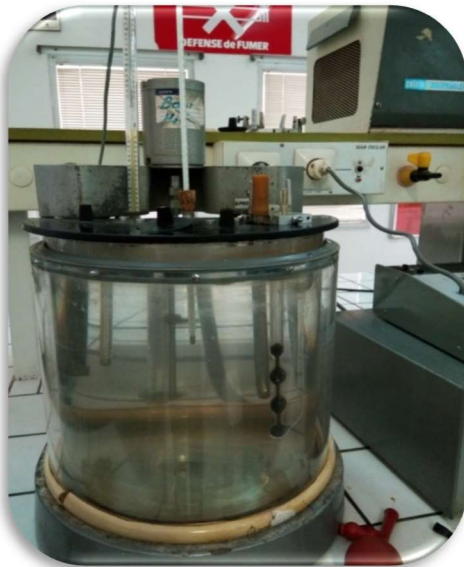
Figure III.7 : Mesure de la viscosité cinématique
