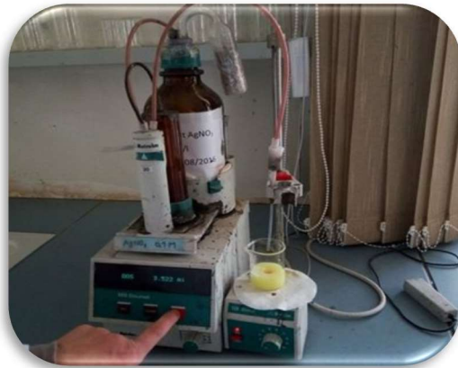
Figure III.4 : Le titrage de l'eau extraite
