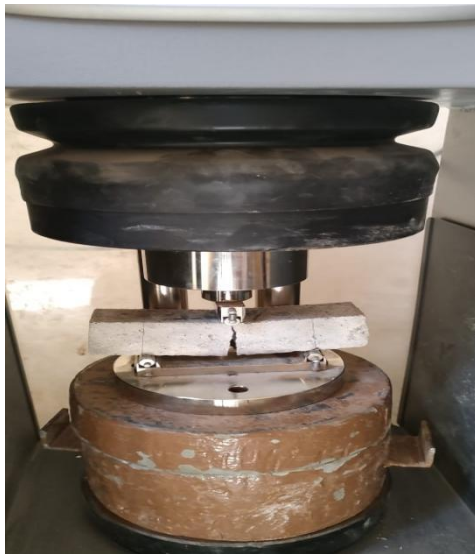
الشكل 19-1 تجربة الشد بالانحناء لعينات الملاط
