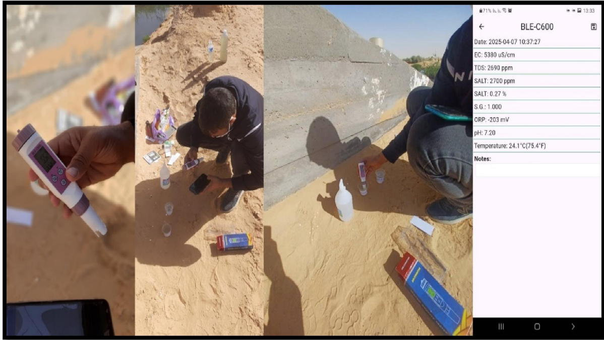
شكل (02) قياسات ميدانية باستخدام جهاز BLE-C600.
