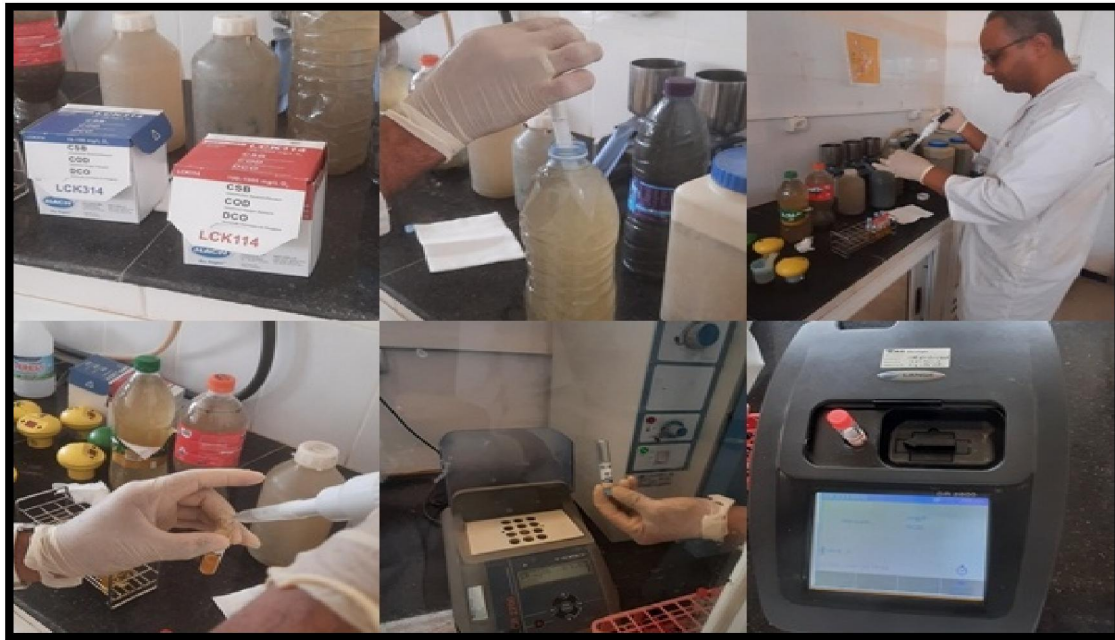
شكل (04) الأجهزة و الأدوات المستخدمة في قياس DCO.
