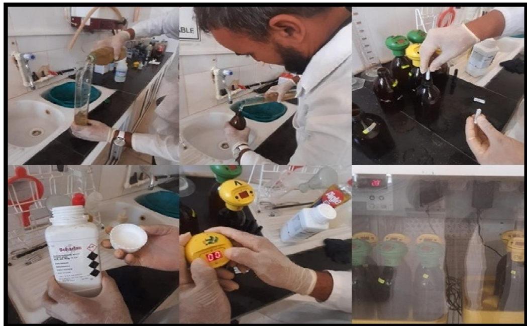
شكل (05) الأجهزة و الأدوات المستخدمة في قياس DBO_5 .
