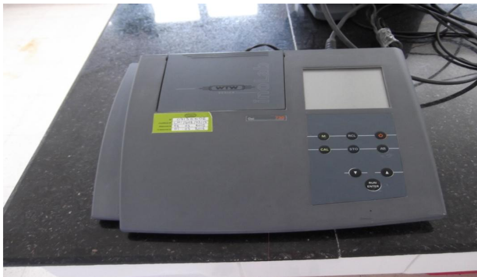
Photo V.3: Oxy-mètre (INOLABO-OXI 730 WTW) (ONA, 2015).
