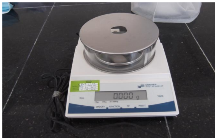
Photo V.7: Balance électrique (TP-303) (ONA, 2015).
