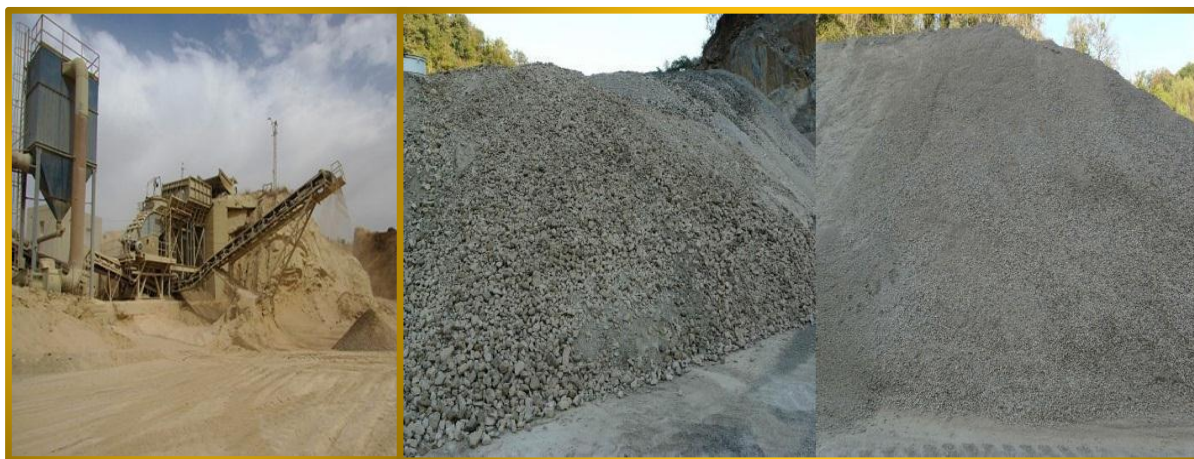
Figure II .2 : Exemple des granulats de carrière
