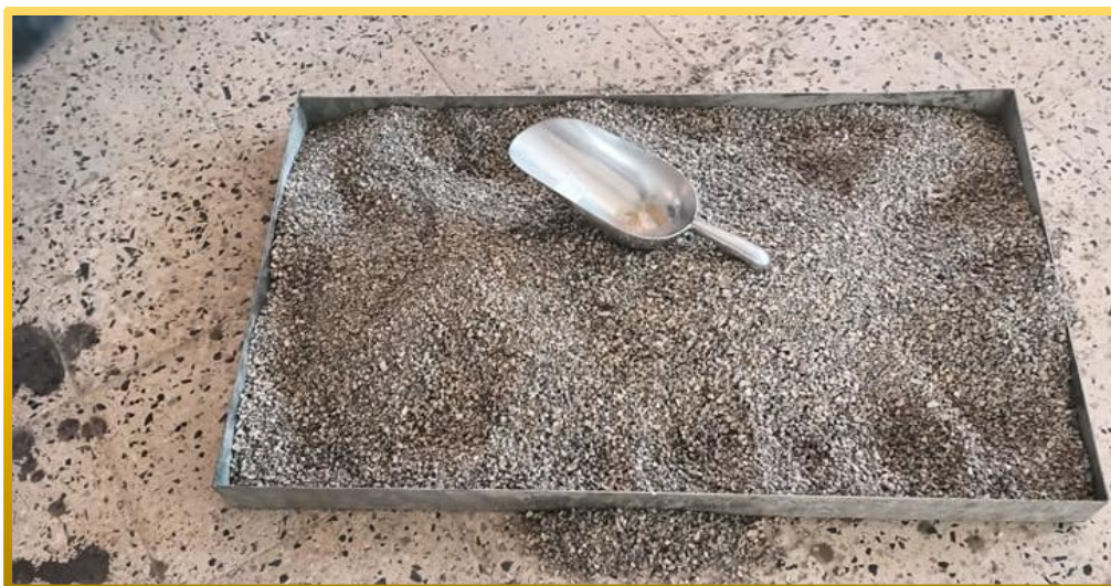
Figure III .7 : Étapes de préparation des granulats du béton de démolition.
