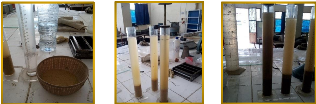
Figures III.6: Principe de l'essai d'équivalent de sable.
