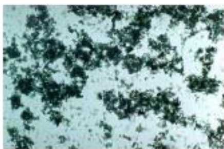
Suspension d'eau et de grains de ciment
