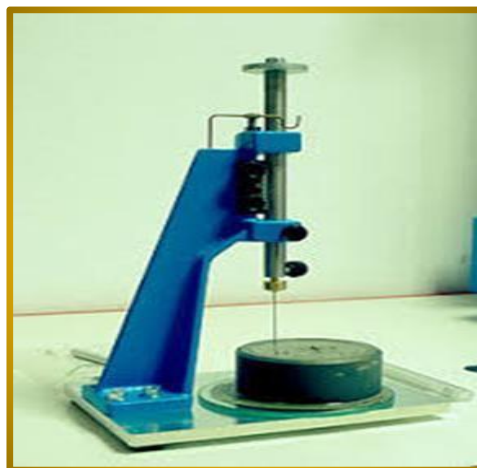
FigureI-14 : Détermination du temps de début de prise.
