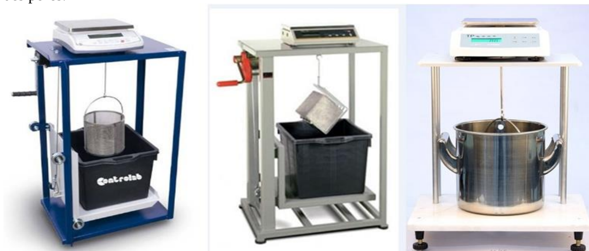
Figure III.21: Types d'appareillages de pesée hydrostatique.
