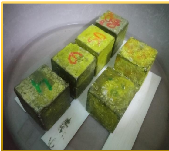
Figure III.19: L'essai d'absorption par capillarité.
