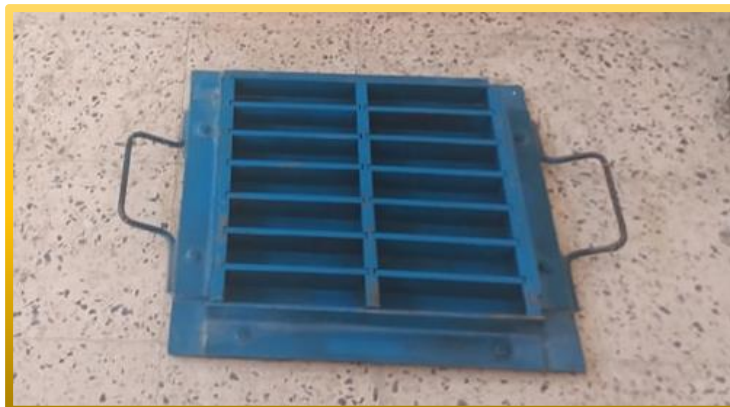
Figure III.10. Moule de confection des éprouvettes 4×4×16 cm.
