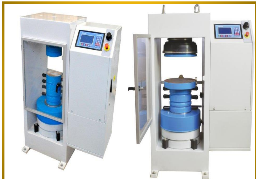
Photo III.15: Deux (02) Appareillages de la compression.
