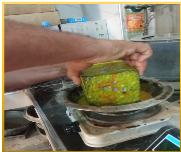
Figure III.19: L'essai d'absorption par capillarité.
