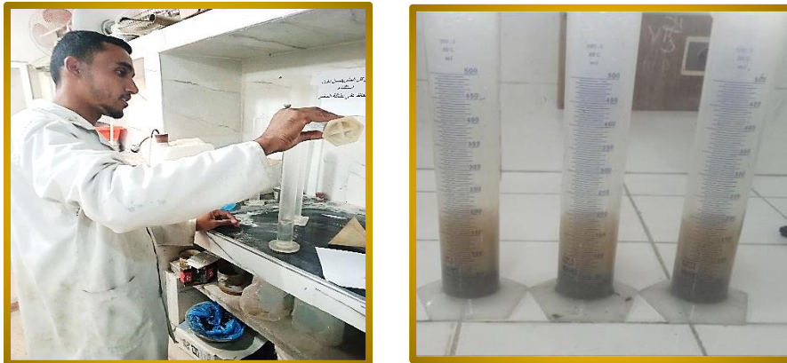
Figure III.5 : Essai de la détermination de la masse volumique absolue du sable.
