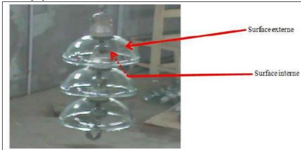
Figure II. 5 Surfaces interne et externe d'un élément de la chaîne d'isolateur.
