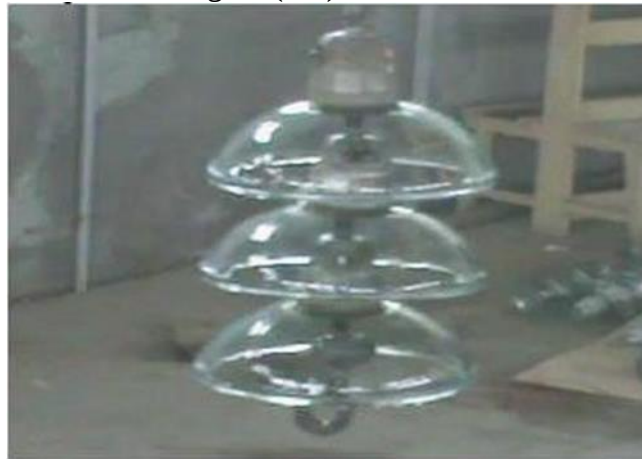
Figure II. 4 Chaîne d'isolateurs U120B étudiée.
