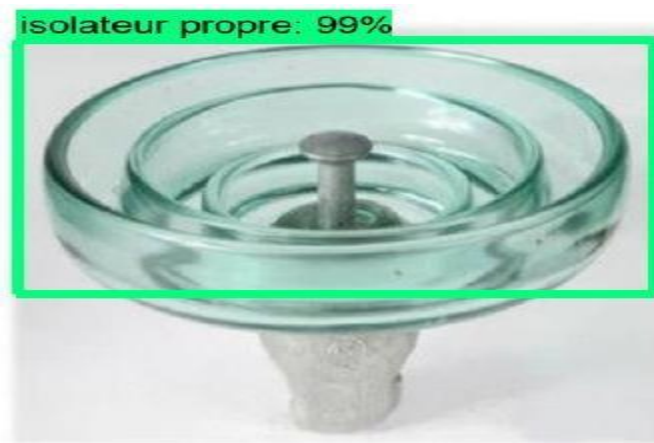
Figure III. 28 Isolateur en état propre.
