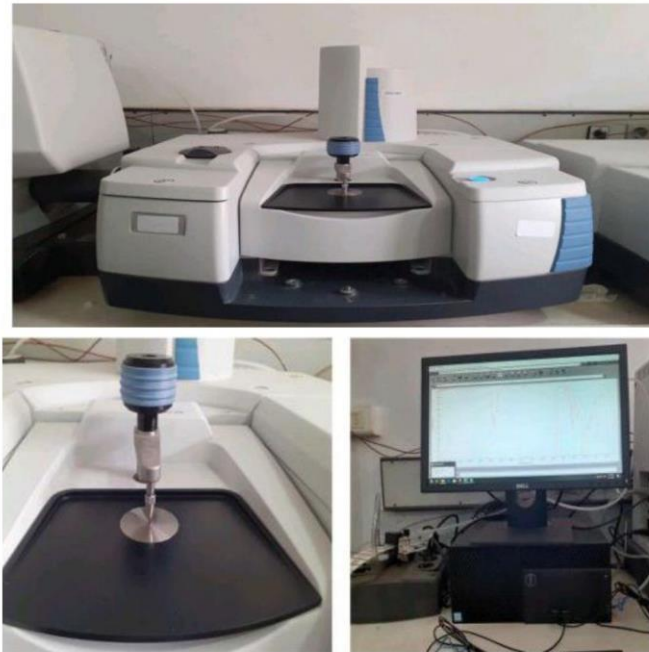
Figure 17: spectromètre infrarouge à transformée de fourier (ATR) (FERCASF et al. , 2009).
