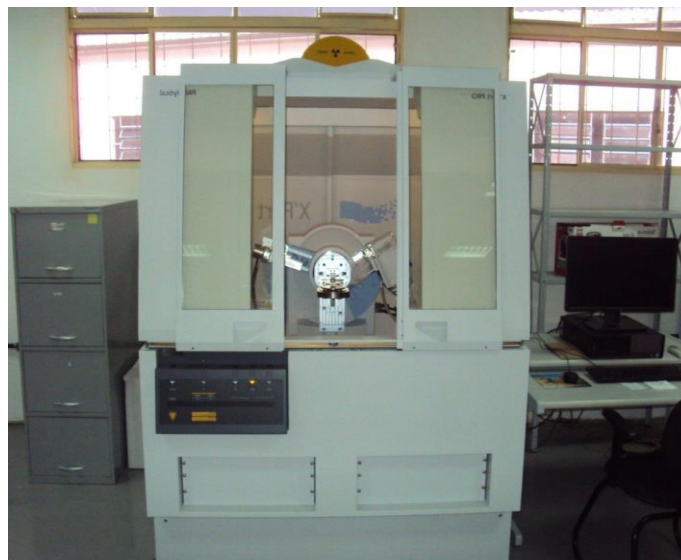
Figure 10 : chambre de diffraction (LAIDI, 2017).
