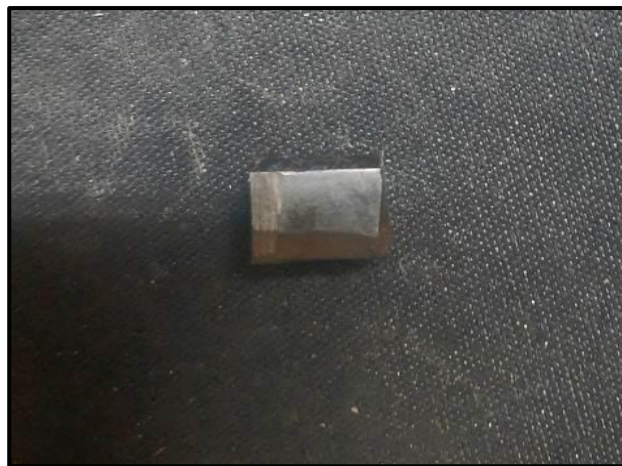
Figure IV.5: Corrosion survenue sur l'échantillon après son extraction de la solution
