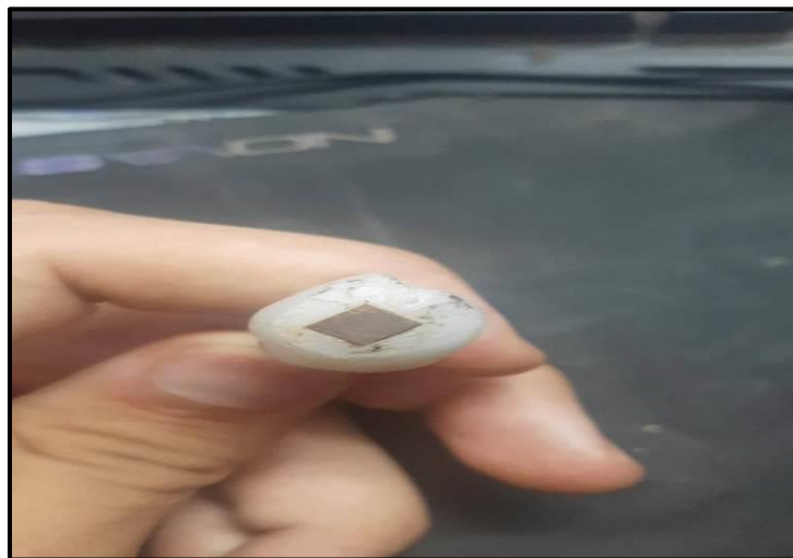
Figure IV.8 : Changement de Couleur Electrode de travail après l'opération
