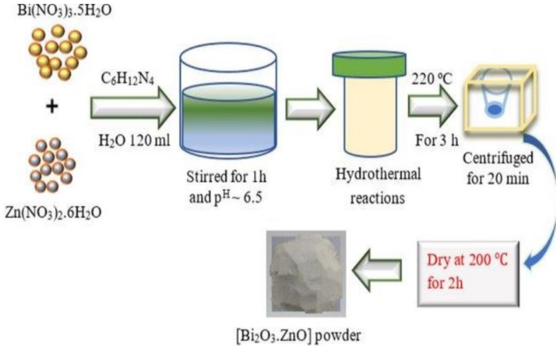
الشكل 1.9: رسم تخطيطي تمثيلي للعملية الحرارية المائية [43]
