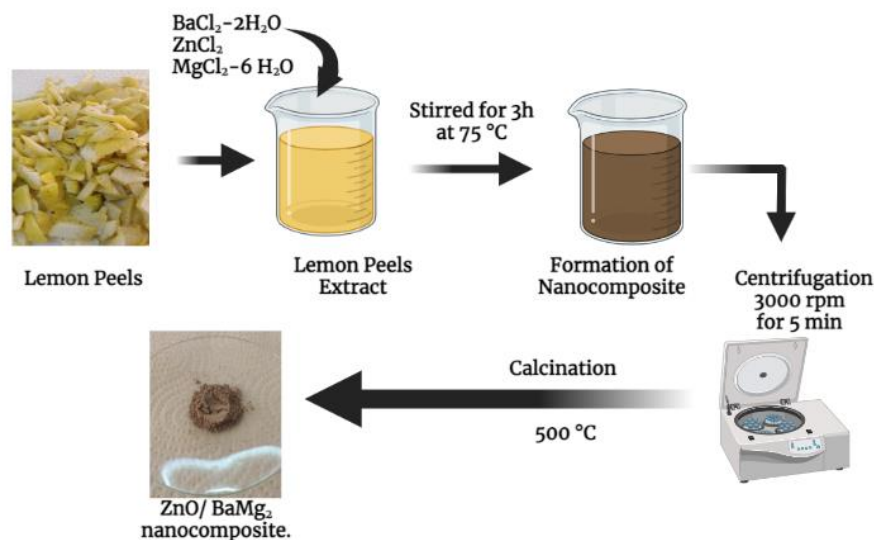
الشكل II. 7: طريقة تحضير المركب النانوي ZnO/BaMg_2 باستخدام مستخلص قشور الليمون
