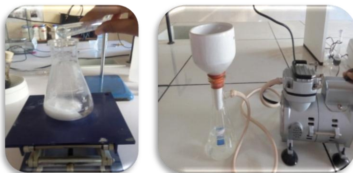
Figure III.6. Apparence de cristaux blancs et filtration sous vide
