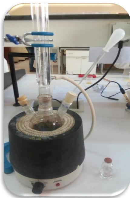
Figure III.4. Montage à reflux pour la synthèse de l'acide benzoïque
