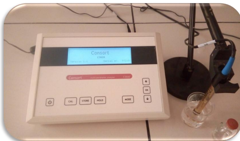
Figure III.9. pH-mètre utilisé type Consort multi-parameter analyser C3020
