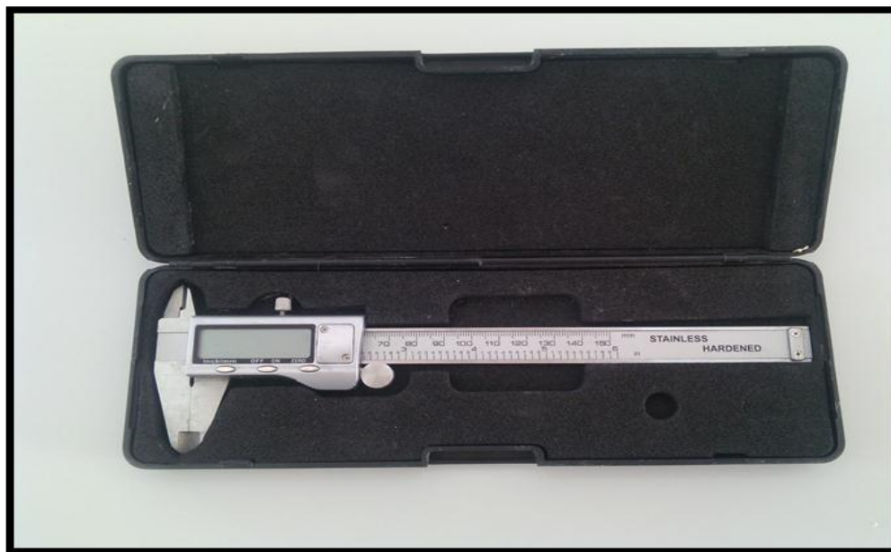
Annexe 11 : Pied à coulisse automatique utilisé dans les mesures des diamètres des zones d'inhibitions et l'augmentation de l'œdème.
