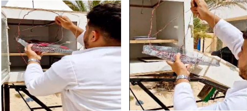
Figure(III- 44): Placer l'échantillon à l'intérieur du séchoir solaire
