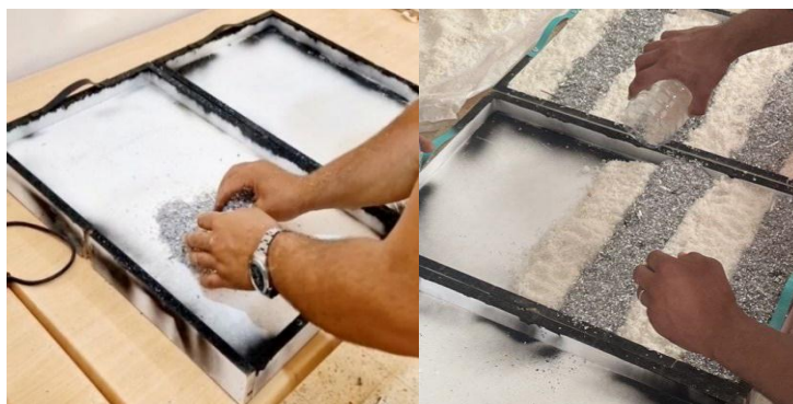
Figure (III- 32): l'installation de l'absorbeur étape 1
