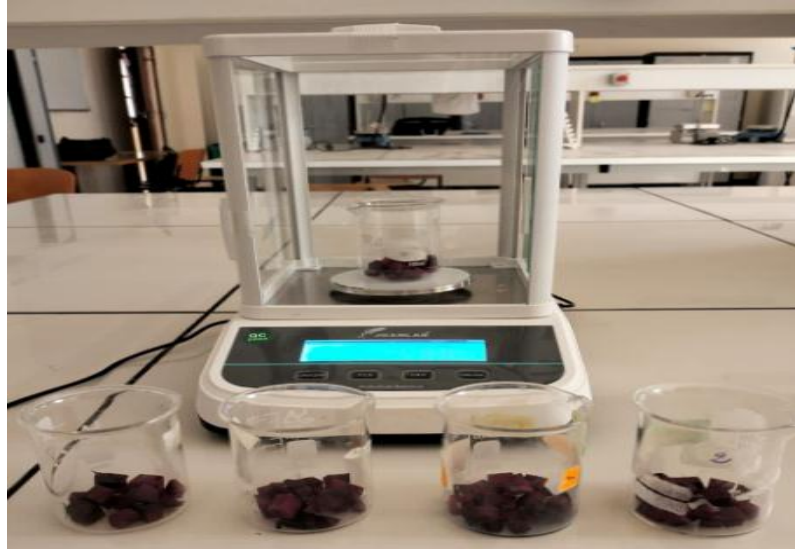
Figure (III- 38): pesé l'échantillon humide
