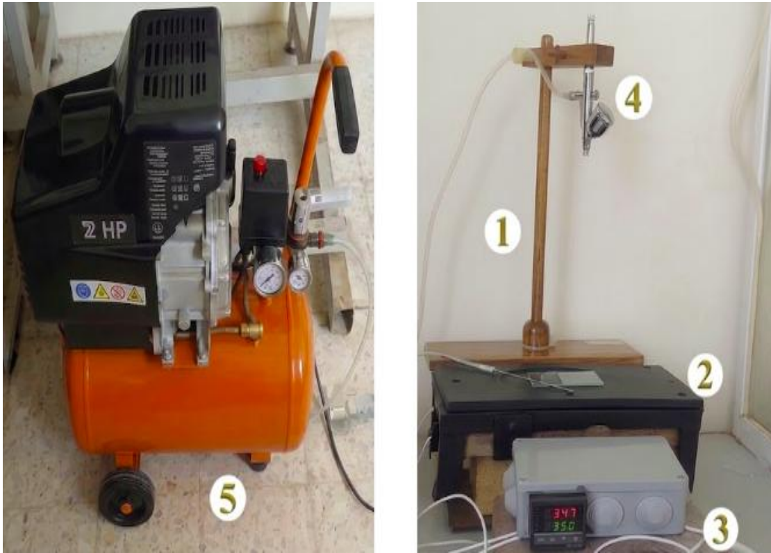
الشكل (2-III): التركيب التجريبي لترسيب الأغشية الرقيقة بتقنية (SPT) .
