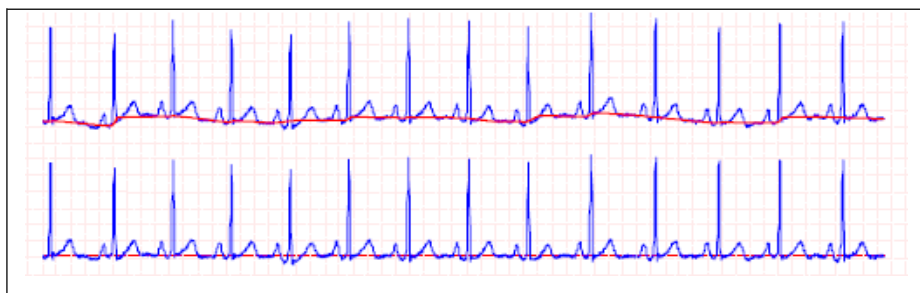
Figure III-3-5: en haut signal original observé lors d'enregistrements en bas signal après filtrage.
