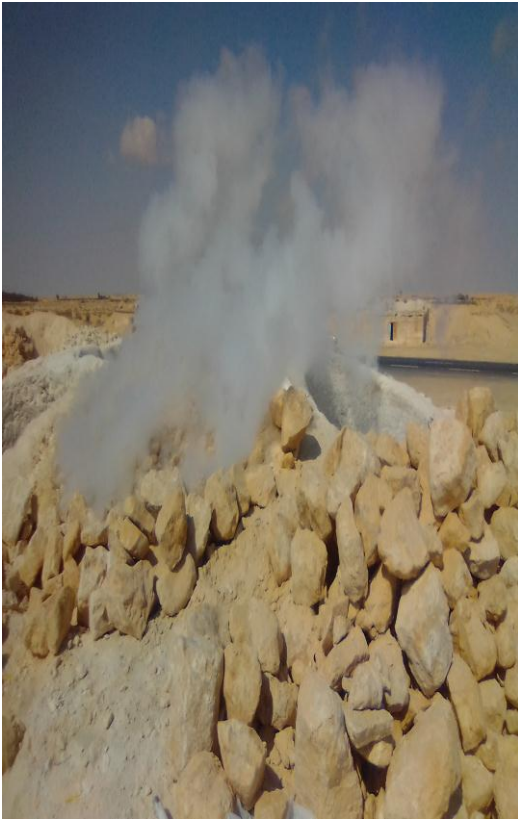
صورة رقم 26: عملية حرق الجبس
