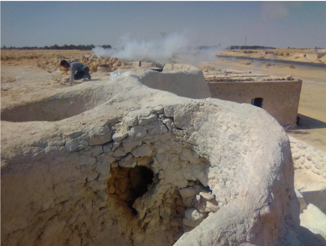
الصورة رقم 33: الفرن التقليدي لتحضير الجبس
