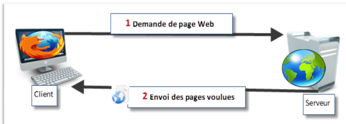
Figure I.1. Fonctionnement d'un site web statique.
