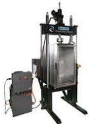
Figure 2.26: retrait thermique empêché (AASHTO, TP10-93)
