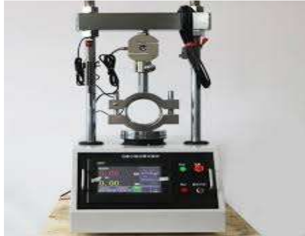
Figure 2.30 : Essai de stabilité
