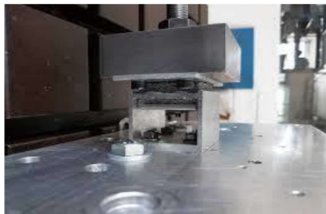
Figure 2.31: compression simple ou répété
