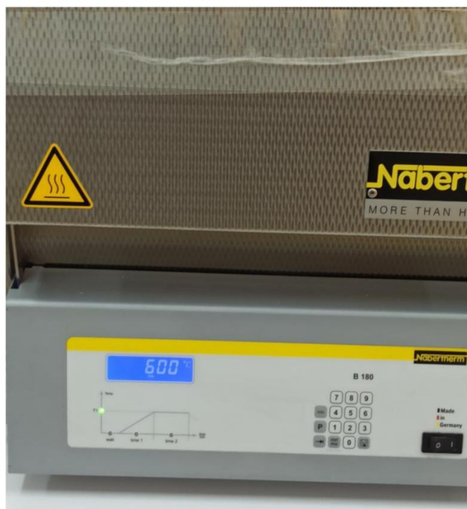
Figure II.19: La calcination de poudre obtenue à 600 °C.
