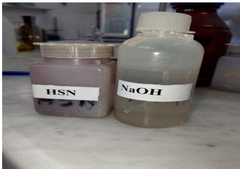
Figure II.4. Réactifs utilisés pour le dosage du calcium : NaOH et indicateur HSN.
