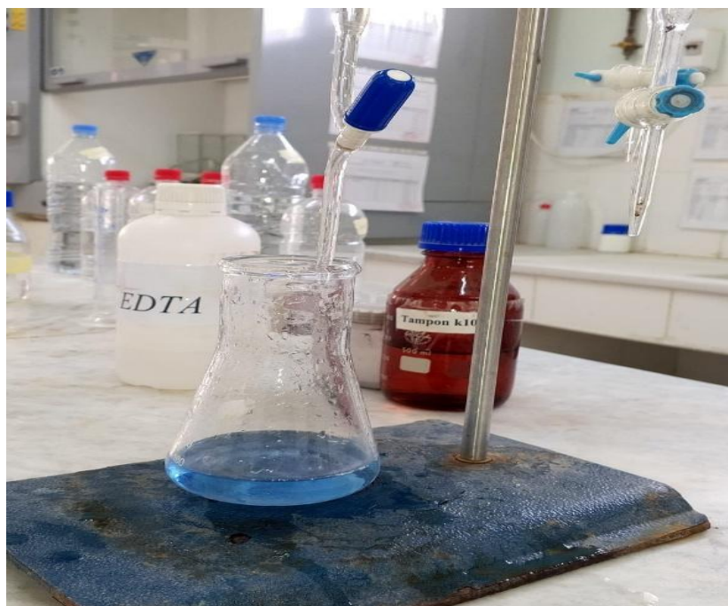
Figure II.3. Dispositif de titrage complexométrique pour la détermination du calcium.
