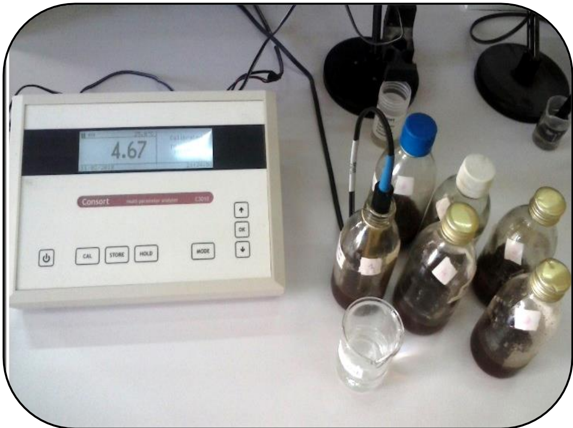
Figure 21: mesuré le pH de l'extrait enzymatique des souches sélectionnées par de pH mètre du marque CONSORT
