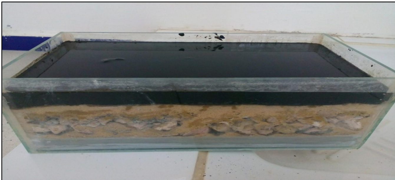
Figure N°6 : Bassin de séchage des boues
