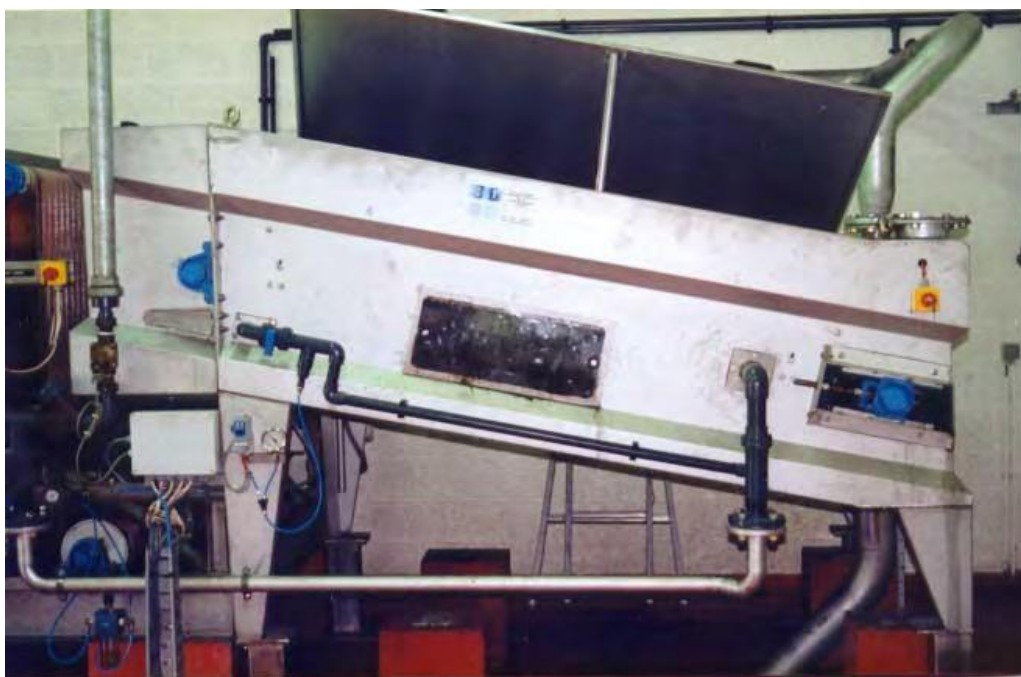
Figure 3: Exemple de table d'égouttage.
