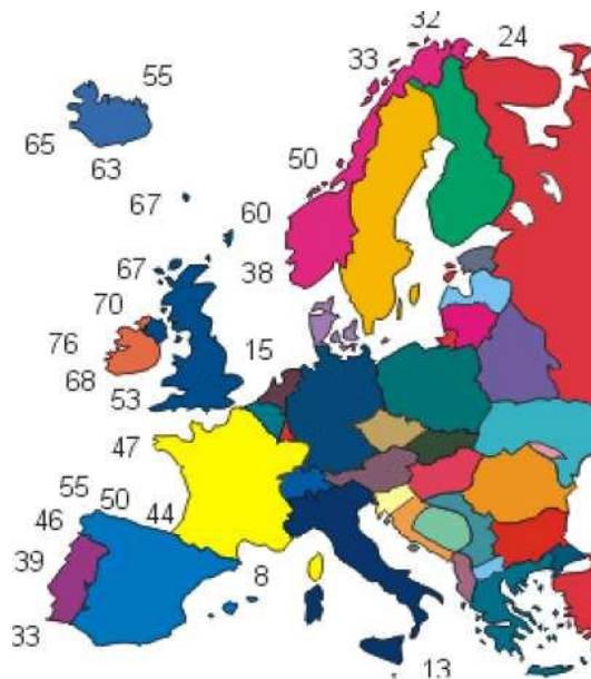
Figure(2.3) – carte des ressources énergétiques de la houle en Europe (en kW/m)
