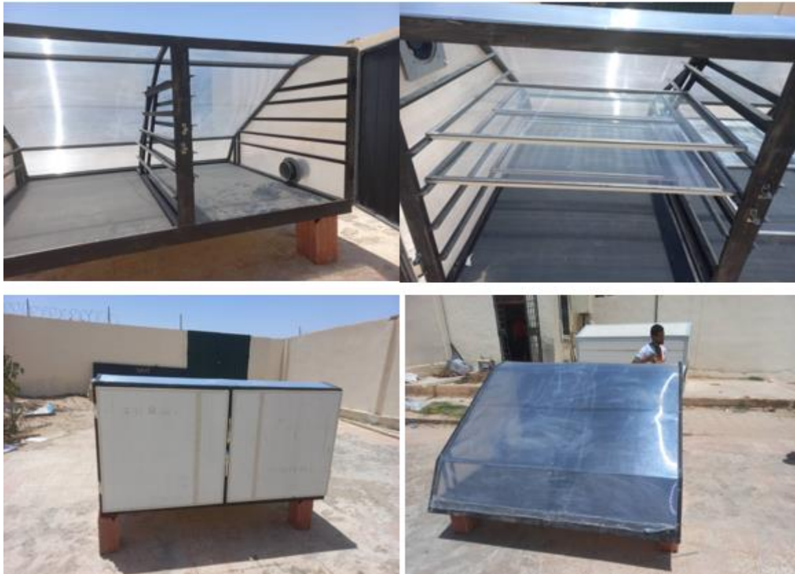
Figure II-27: Vues de différents côtés du séchoir réalisé
