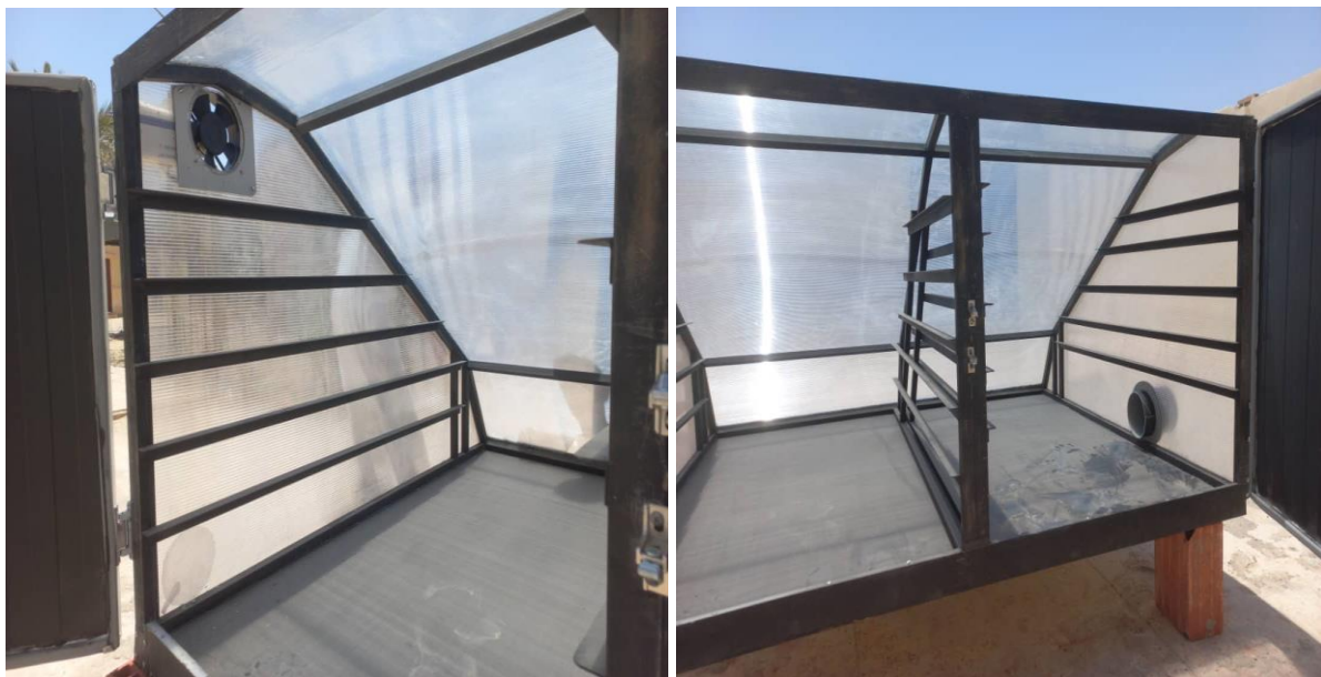
Figure IV-1: Vue intérieure de la sécheuse montrant l'entrée d'air et la position du ventilateur
