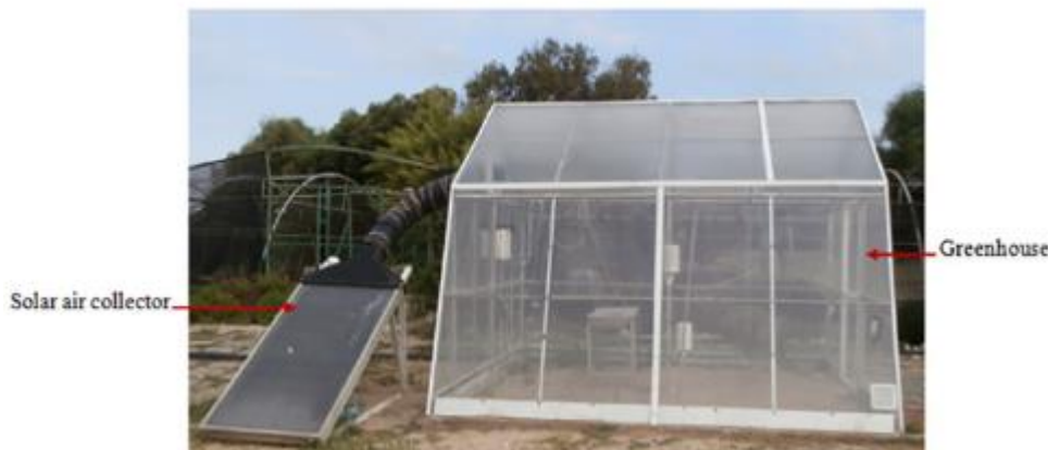
Figure II-23: Photographie du séchoir solaire à effet de serre [35].
