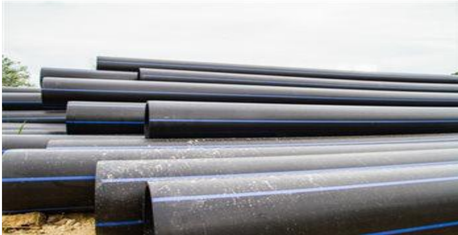
Photo. II.2: Conduites en (PEHD)
